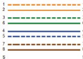
Схема разводки (T568B) PASS
